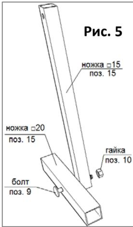
5.2.1. Соберите Т-образные ножки для крепления теплицы в грунт как показано на рис. 5.
